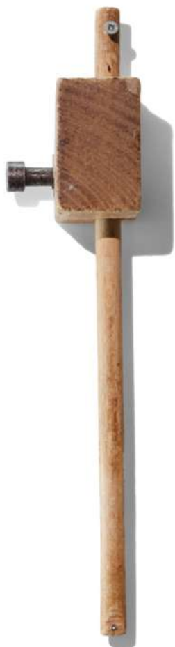
Graffietto. Usato per segnare il legno. Wood-marking utensil.
