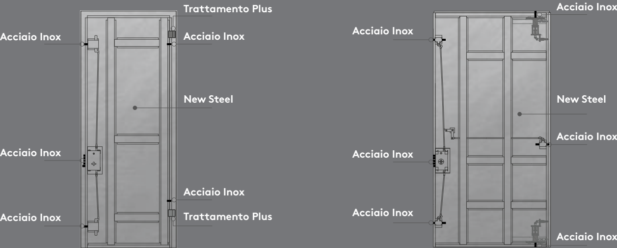
Kit materiale Plus da utilizzare nel caso di installazioni in condizioni climatiche aggressive.
