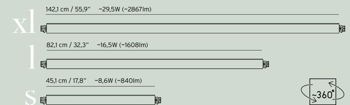
Barre lineari disponibili in 3 differenti lunghezze che si innestano su satelliti circolari. Le barre lineari luminose possono contenere o non contenere la sorgente luminosa, sono rotabili a ~360° per permettere, quando luminose, un completo orientamento della luce. Le barre lineari non luminose hanno una mera funzione architettonica e possono essere usate per il completamento delle forme geometriche desiderate.
