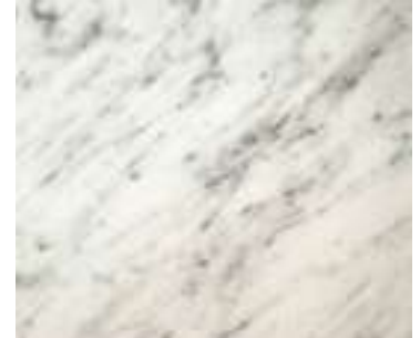
VENATURA ECCESSIVA HIGHLY MARKED VEIN
