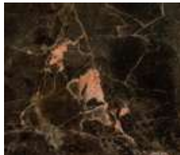
TRACCE DI ARGILLA ROSSA TRACES OF RED CLAY
