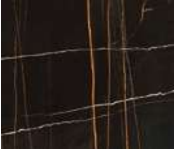
VENATURA ECCESSIVA HIGHLY MARKED VEIN
