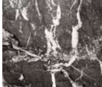
VENATURA ECCESSIVA HIGHLY MARKED VEIN
