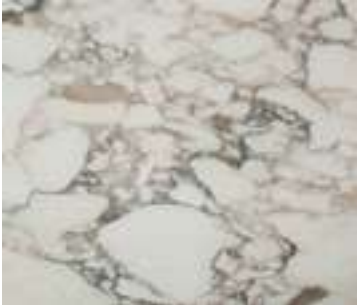
VENATURA ECCESSIVA HIGHLY MARKED VEIN
