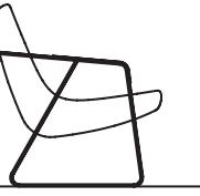
Il sedile e lo schienale, uniti e simmetrici, si appoggiano su una struttura di acciaio: come un unico filo di metallo che percorre tutta la struttura, regalando leggerezza inattesa e comfort alla morbida seduta.
