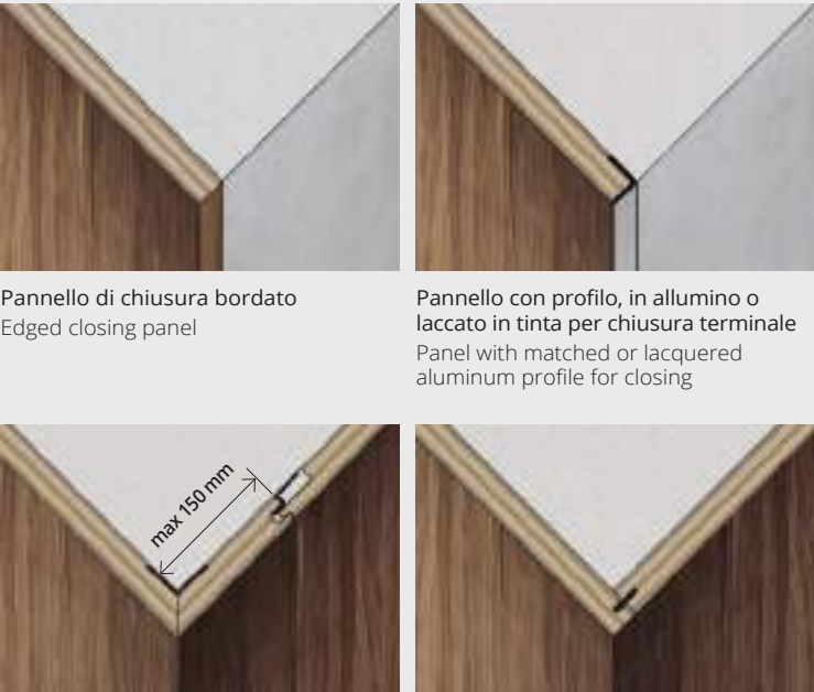
Pannello assemblato a 45° con un lato di dimensione max 150 mm 45° assembled panel with one side maximum dimension 150 mm
