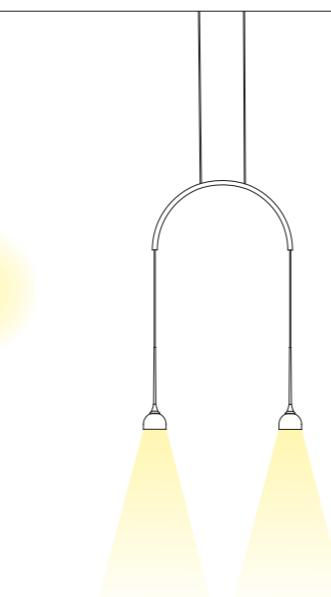
*System kleiner Pendelleuchten mit diffusem oder direktem Licht.*
