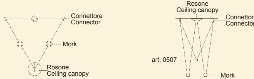
Esempi di installazione geometriche - Examples of geometric configuration
