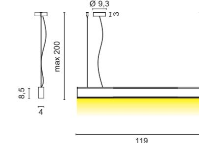
Lampada a sospensione di grande dimensione realizzata in alluminio tornito.
