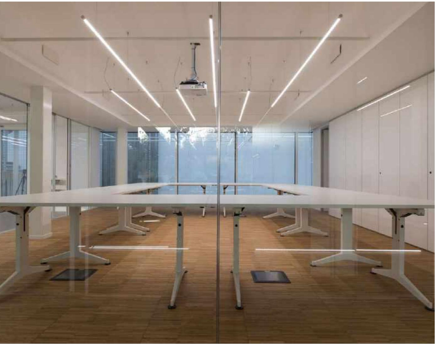
Lampada o composizione di lampade a sospensione dal disegno semplice ed essenziale, realizzate per fornire una Luce diretta continua e uniforme nel rispetto del più elevato confort visivo. Il corpo è realizzato con un profilo di alluminio, un diffusore in policarbonato opale e cavo di alimentazione coassiale.
