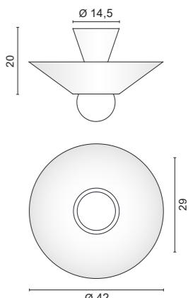
Lampade a plafone di grande dimensione realizzata in alluminio tornito.
