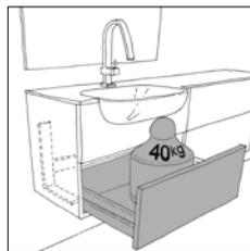
Sistema di fissaggio per basi sospese, portata 120 kg per ogni singola base. Portata max cassetto 40/70 kg.
