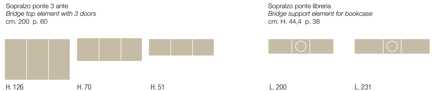
Sopralzo terminale 1 anta Corner terminal top element with 1 door cm. L. 60 x 60 p. 60 Sopralzo ad angolo Corner top element cm. L. 126 x 126 p. 60 Cassettiere Chest of drawers cm. p. 60 H. 70 H. 70 L. 60 h. 134 L. 60 h. 64 L. 115 h. 64 L. 100 h. 82
