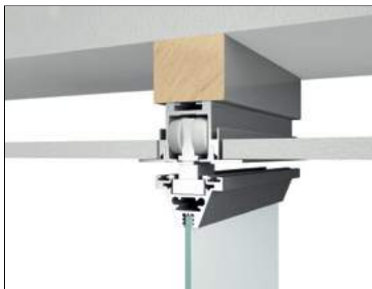
Travi di scorrimento ad incasso a soffitto a 1 via One way ceiling built-in sliding rail
