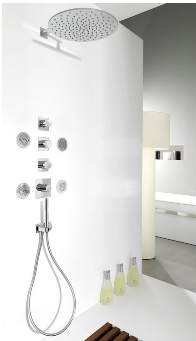
GIRO Termostática encastre con termoelemento de cera incorporado. Conexiones de 3/4". Incluye válvula anti-retorno y stop de seguridad a 38°C.
